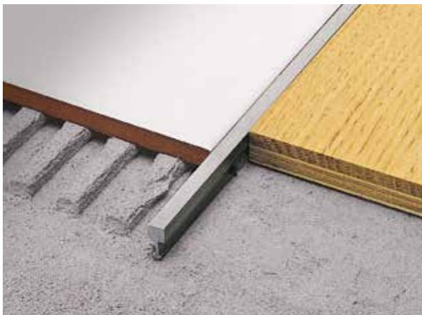
Los perfiles linetec AD fraccionan pavimentos al mismo nivel colocados con cola ofreciendo una superficie a la vista de 5 mm. El espesor de la cabeza de 4 mm, permite el lijado contextual al suelo. El particular vástago de flecha garantiza un agarre mecánico resistente con el adhesivo utilizado. Ideal para combinar con suelos de mármol o madera.
